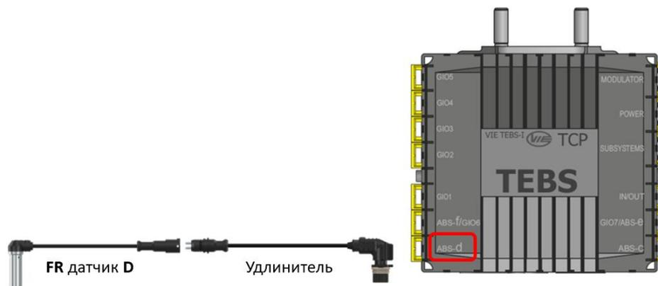
Возможно, при монтаже разъема и датчика были деформированы контакты. Проверьте разъем. Элементы контактной группы деформированы/ погнуты или имеют овальную форму? Если это так, замените удлинительный кабель или аккуратно подогните втулки контактов небольшой отверткой.
