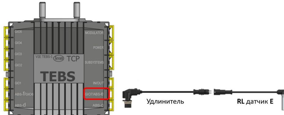
Если определить неисправность не удалось, замените датчик скорости вращения колеса E.
