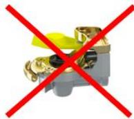
Нет сигнала по желтой соединительной головке
