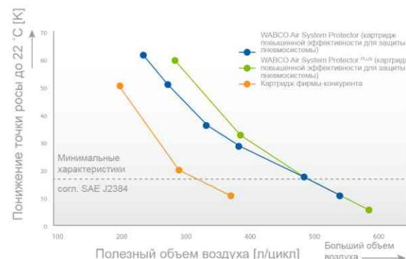
Условия проведения испытаний: испытательная установка проверки осушающей способности согласно SAE J2384; механическая установка осушения воздуха с баком регенерации вместимостью 6 л, вкл.: 11 бар, выкл.: 12 бар
