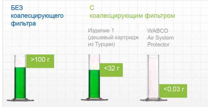
Условия проведения испытаний: Двухцилиндровый компрессор рабочим объемом 704 см<sup>3</sup> при высокой температуре эксплуатации, давление 12,5 бар и продолжительность включения 50%; расчет основан на измерении потока установки осушения воздуха
